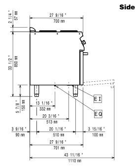
El = Electrical inlet (power) EQ = Equipotential screw
