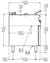
**EI** = Electrical inlet (power) **EQ** = Equipotential screw
