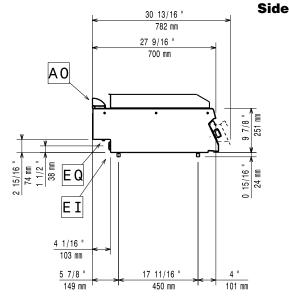
El = Electrical inlet (power) EQ = Equipotential screw
