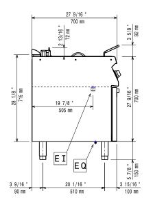
El = Electrical inlet (power) EQ = Equipotential screw
